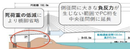
混合桁接合位置の検討
