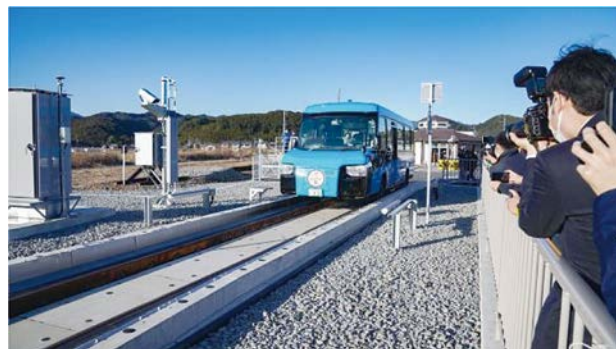
阿波海南駅モードインターチェンジの様子
